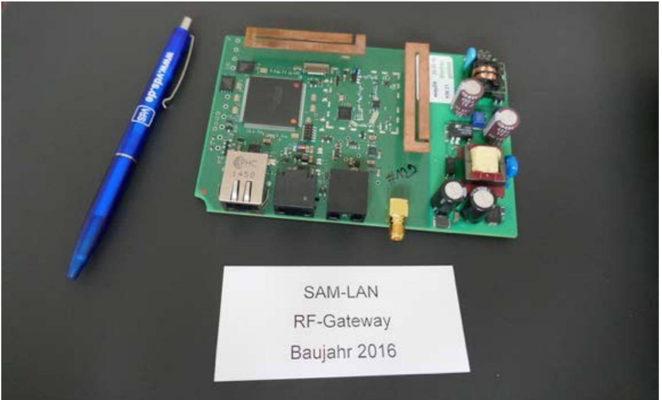
Das SAM-LAN RF-Gateway ermöglicht die Vernetzung von Ventilen. © Uwe Sievers
